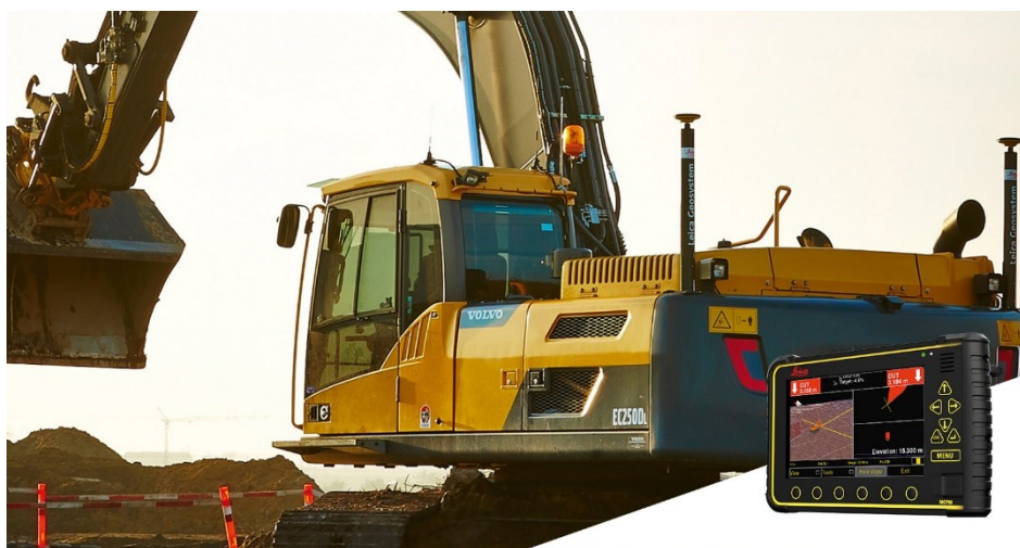
Abbildung: Bagger mit 2 GNSS-Antennen und Steuerbox
