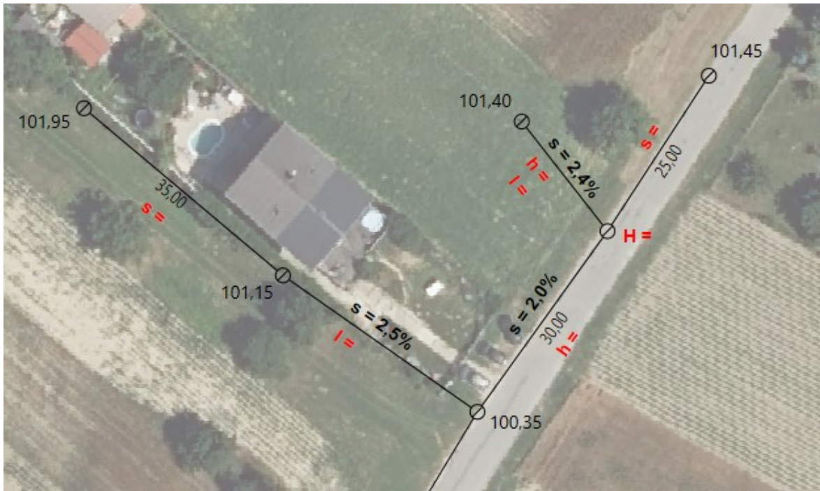
Abbildung: Planung einer Abwasserentsorgung
