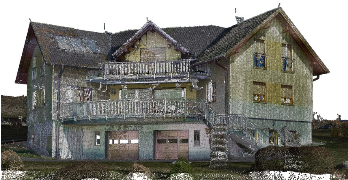
Abbildung: Punktwolke aus unterschiedlichen Laserscanner- und Drohnen-Aufnahme
