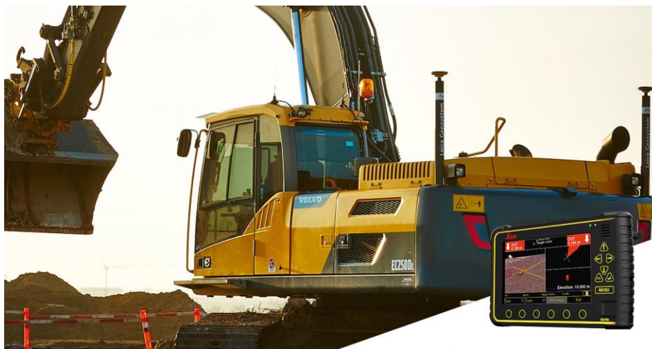
Abbildung: Bagger mit 2 GNSS-Antennen und Steuerbox
