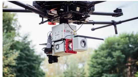
Abbildung: Drohne mit LIDAR-Sensor
