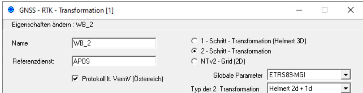
Abbildung: Parameter der Transformation – Globale Parameter vom BEV
