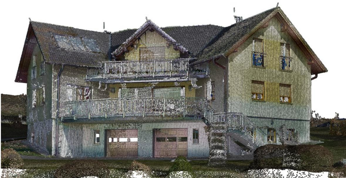
Abbildung: Punktwolke aus unterschiedlichen Laserscanner- und Drohnen-Aufnahme
