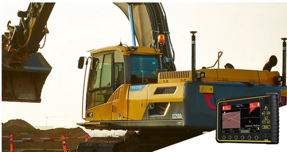
Abbildung: Bagger mit 2 GNSS-Antennen und Steuerbox
