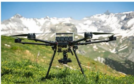
*Abbildung: Drohne mit Kamera bzw. Laserscanner – ausgestattet mit GNSS-Antennen*
