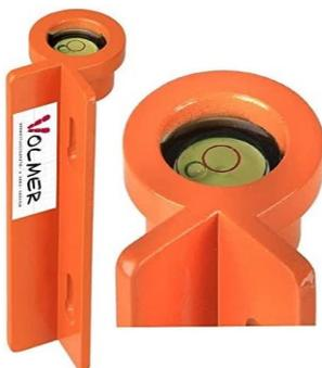
Sie dienen dazu, die Latte vertikal einzurichten. Dies ist notwendig, um die Genauigkeit der Ablesung zu erhöhen. Sie bestehen aus einem Winkeleisen, auf deren Außenseite eine Dosenlibelle befestigt ist. Der Winkel wird an die Latte gehalten und diese so lange geschwenkt, bis die Dosenlibelle eingespielt ist.
